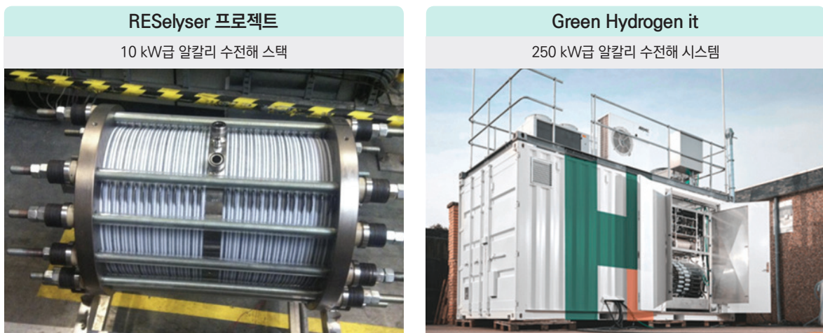
그림 29 RESelyser 프로젝트 개발 10 kW급 알칼라인 수전해용 스택 및 Green Hydrogen 社 개발 250 kW급 알칼라인 수전해 시스템
