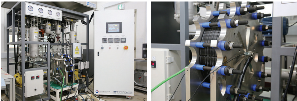
그림 30 한국에너지기술연구원 개발 알칼라인 수전해 시스템 및 스택
